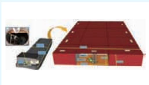
2017.04.03 사망 2명 바지선 검사 및 수리 작업 (바지선 부력 탱크 내부 점검 중 질식 사고)
